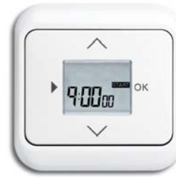
Busch-Kurzzeittimer Frei programmierbarer Kurzzeittimer im Bereich von 1 Sekunde bis 9 Stunden, 59 Minuten und 59 Sekunden. Die aktuell eingestellte Zeit bleibt nach Ablauf erhalten und kann immer wieder aufgerufen werden. Der Kurzzeittimer lässt sich jederzeit anhalten (elektronische „Eieruhr“). In den Einstellungen des Gerätes lassen sich die programmierten Zeiten vor unbefugtem Zugriff bei Bedarf schützen.
