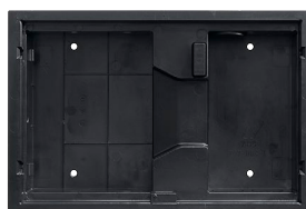
Unterputz-Montagedose Einbaumaß Unterputz (H x B x T): 152 mm x 235 mm x 60 mm Einbaumaß Hohlwand (H x B x T): 146 mm x 227 mm x 50 mm. Maße (H x B x T): 155,58 mm x 237,68 mm x 52 mm
