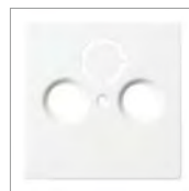
Zentralscheibe 1) 2) als Abdeckung für handelsübliche Antennensteckdosen Mit 2 Anschlüssen. Nach DIN 45330. Radio/TV/SAT. Mit zentraler Befestigung M3. Schutzart Gerät: IP 20
