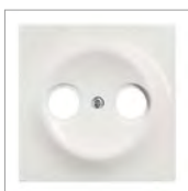
Zentralscheibe 1) als Abdeckung für handelsübliche Antennensteckdosen Mit 2 Anschlüssen. Nach DIN 45330. Mit zentraler Befestigung M3. Schutzart Gerät: IP 20
