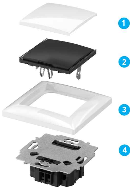
Bild: Das Busch-Trevion Keypad besteht aus einer Abdeckung (1), einem Keypad (2), welches als 1-fach-, 2-fach-, 3-fach- oder 4-fach-Touchsensor genutzt werden kann, einem Schalterraahmen (3) und einem Busankoppler für KNX, Busch-free@home® oder Busch-flexTronics® Einsatz (4).
