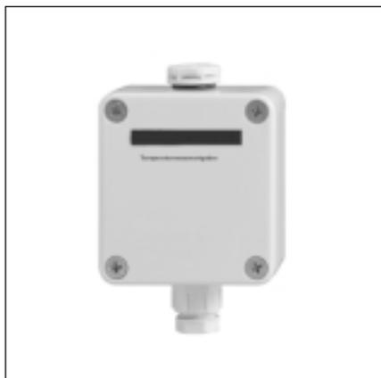
Der Temperaturmesswertgeber ist zur Messwertaufnahme für die Wetterstation vorgesehen. Er dient zur Erfassung der Lufttemperatur in oder in der Umgebung von Gebäuden, um beispielsweise eine Heizung einzuschalten, wenn eine bei der Wetterstation parametrierbare Grenztemperatur unterschritten wird.
