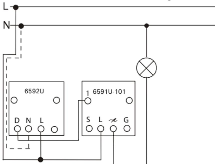
Het is mogelijk max. 5 nevenaansluitingen parallel te gebruiken. De N-aansluiting wordt alleen bij verlichte nevenaansluitingen gebruikt!
