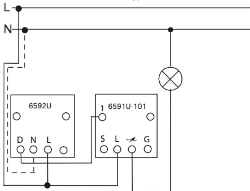
Un maximum de 5 commandes supplémentaires peuvent être utilisées en parallèle. Le raccordement N n'est nécessaire qu'en cas de commandes supplémentaires éclairées !
