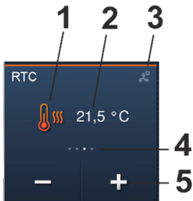
Afb. 8: Overzicht van de bedienings- en indicatie-elementen van de ruimtetemperatuurregelaar
